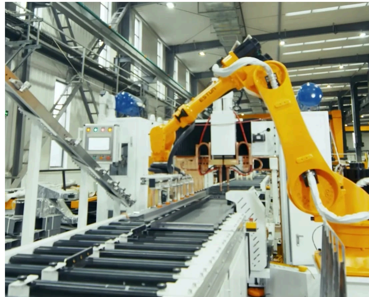
Transfert robotisé sur une ligne de production. Extrait d'une vidéo ESTUN.
